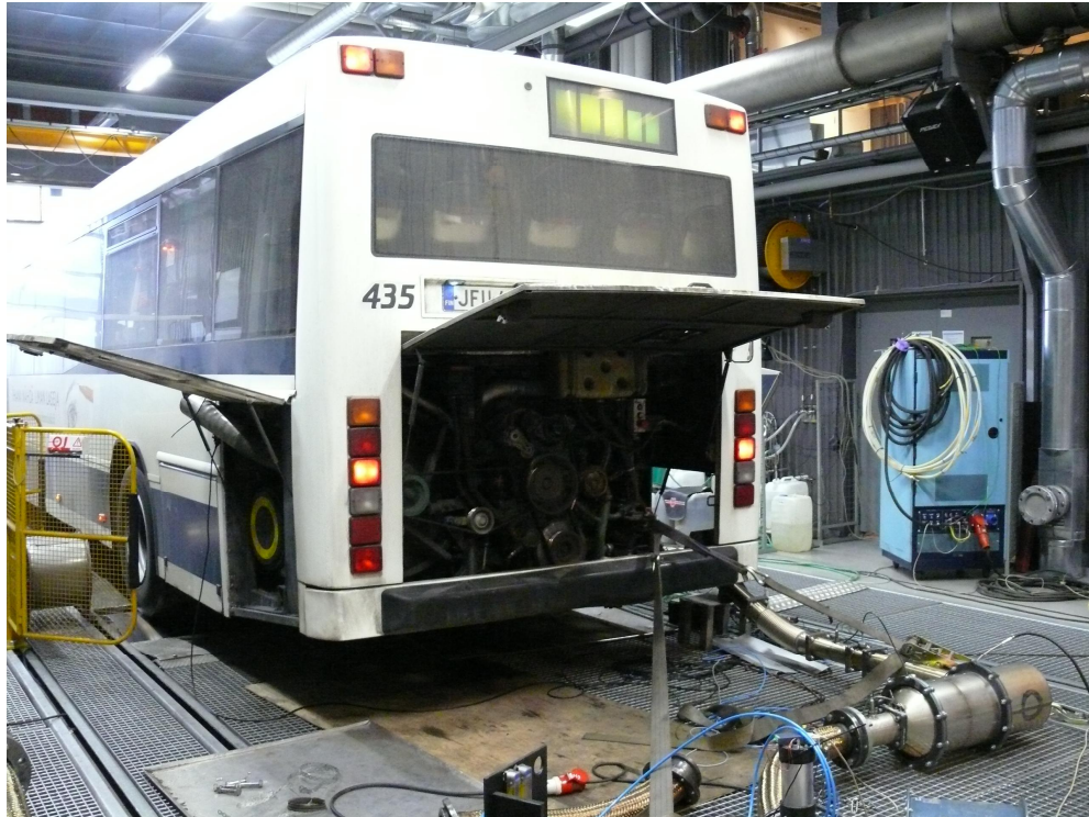
Kuva 25. Retrofit SCR + DPF järjestelmän testausta kaupunkibussissa.
